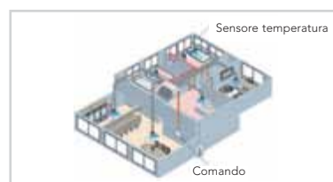
Filocomando a distanza con sensore di temperatura.
